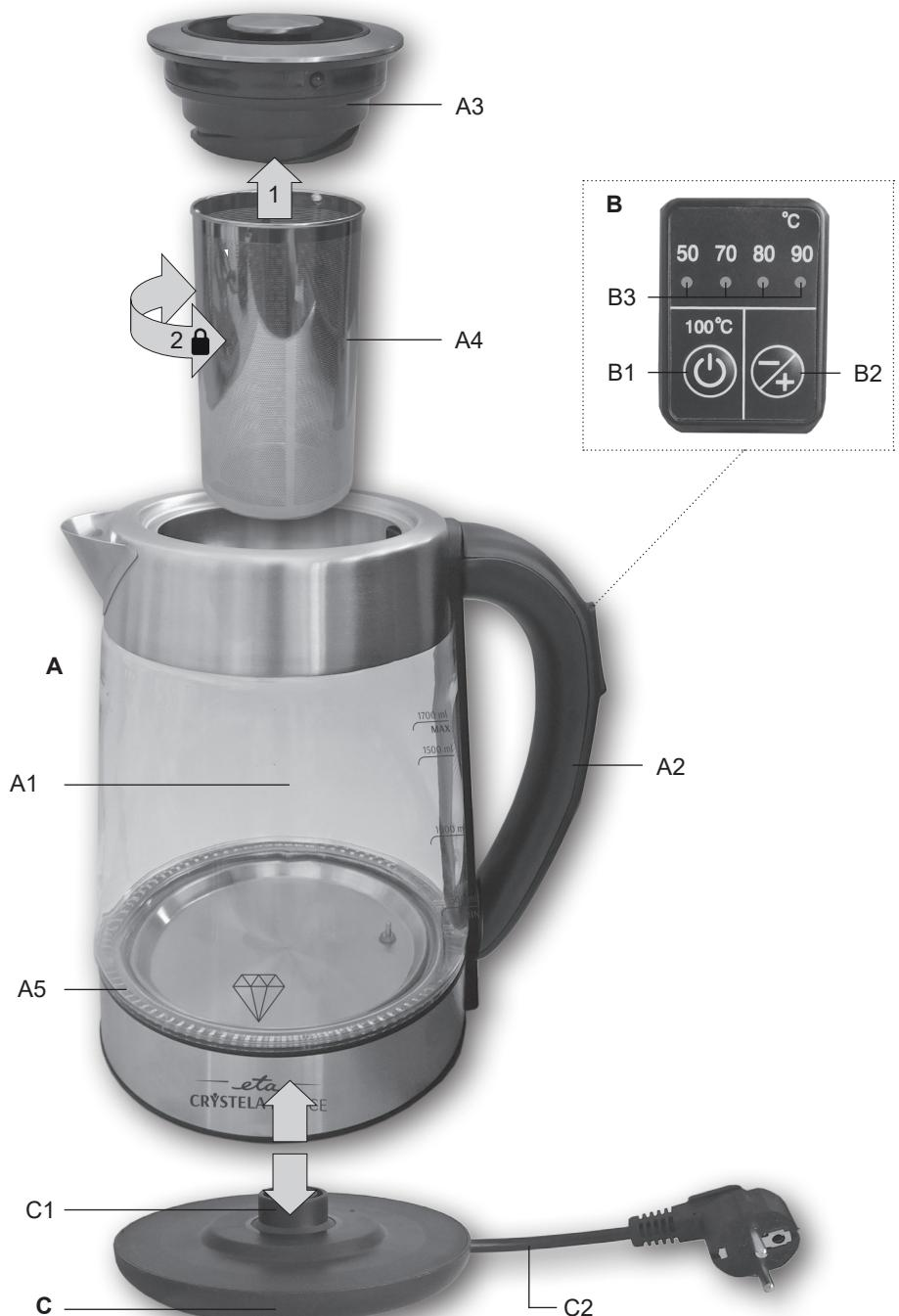
Chwycić czajnik za uchwyt **A2**, zdjąć pokrywę **A3** przez proste wysunięcie i napełnić czajnik czystą wodą pitną. Minimalna i maksymalna ilość wody jest oznaczona na znaku wodnym **A1**. Zatrzasnąć pokrywę **A3** z powrotem na swoje miejsce i napełniony czajnik umieścić na podstawę **C** (słyszeć sygnał dźwiękowy i migająca sygnalizacja świetlna **A5**).
