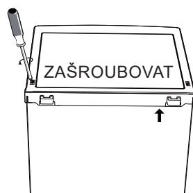
11. Než definitivně dotáhnete šrouby, se zavřenými dveřmi zkontrolujte, zda dveře horizontálně i vertikálně lícují a zda těsnění po všech stranách správně dosedá.
