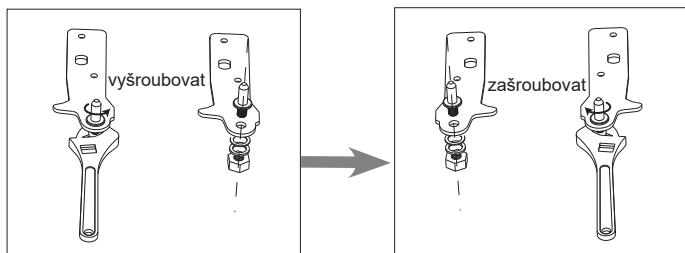
6. Vraťte zpět konzoli na kolík spodního závěsu. Instalujte obě nastavitelné nožky.
