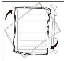
8. Nasadte znovu dveře. Než upevníte horní závěs, zajistěte, aby byly dveře horizontálně i vertikálně ve správné poloze tak, aby těsnění na všech stranách doléhalo.
