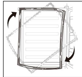
8. Nasadťte znova dvere. Než upevníte horný záves, zaistite, aby boli dvere horizontálne aj vertikálne v správnej polohe tak, aby tesnenie na všetkých stranách doliehalo.
