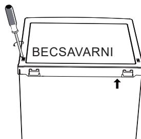
11. Mielőtt véglegesen rögzíti az ajtó csavarjait ellenőrizze az ajtó vízszintes és függőleges pozícióját, illetve a tömítés megfelelő működését!
