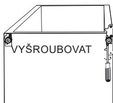
5. Odšrouubujte šrouby a vyjměte kolík spodního závěsu. Otočte konzoli a vraťte ji zpět. Instalujte obě nastavitelné nožky.
