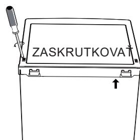
11. Pred definitívnym dotiahnutím skrutiek, so zatvorenými dverami skontrolujte, či dvere horizontálne aj vertikálne lícujú a či tesnenie po všetkých stranach správne dosadá.
