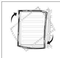
9. Otočte stredný záves o  $180^\circ$ , potom ho presuňte na ľavú stranu. Nasadte spodné dvere späť. Zasuňte kolík stredného závesu do horného otvoru spodných dverí a dotiahnite skrutky.
