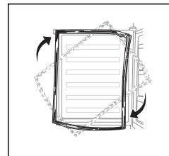
9. Otočte střední závěs o 180°, poté jej přesuňte na levou stranu. Nasadte spodní dveře zpět. Zasuňte kolík středního závěsu do horního otvoru spodních dveří a dotáhněte šrouby.
