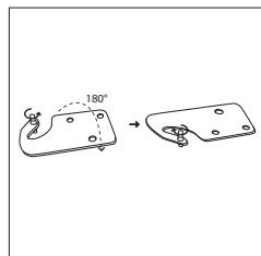
11. Nasadte horní dveře zpět. Než definitivně zašroubujete horní závěs, zkонтrolujte, zda dveře horizontálně i vertikálně lícují a zda těsnění po všech stranách správně dosedá. Poté přiložte závěs a zašroubujte jej do horní části spotřebiče.
