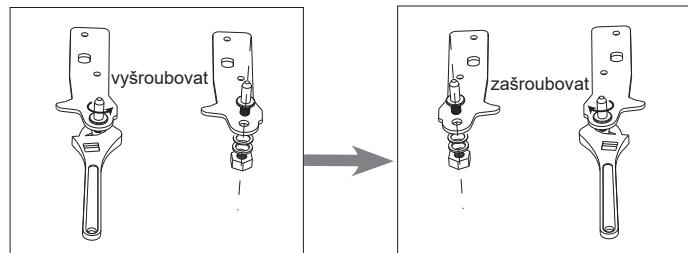
7. Nasadte konzoli na kolík spodního závěs. Vraťte zpět obě nastavitelné nožky. Spodní dveře přesuňte na požadovanou pozici.
