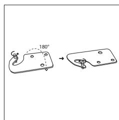
11. Nasadte horné dvere späť. Než definitívne zaskrutkujete horný záves, skontrolujte, či dvere horizontálne aj vertikálne doliehajú a či tesnenie po všetkých stranach správne dosadá. Potom priložte záves a zaskrutkujte ho do hornej časti spotrebiča.
