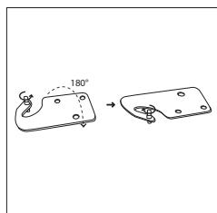
11. Helyezze vissza a felső ajtót. A felső tartó végleges becsavarozása előtt győződjön meg arról, hogy az ajtó vízszintesen és függőlegesen vonalban van-e és a tömítés minden oldalon megflelően helyezkedik-e el. Ezután helyezze el a felfüggesztést és csavarozza azt a készülék felső részéhez.
