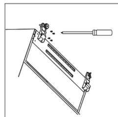
6. Po wypoziomowaniu urządzenia przykręcić drzwi, postępując w odwrotnej kolejności w stosunku do kroków podanych wyżej.
