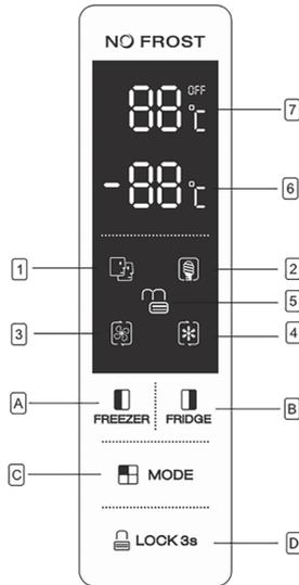
**A készüléken szabályozható a hűtő és fagyasztó részek hőmérséklete. A működtető panelen ezen kívül különböző előre beállított programokat is be tud állítani (egyszerűsítik a készülék használatát).**
